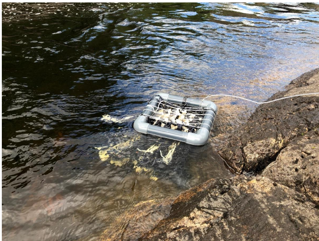
Figur 5. En escapefelle er lett å betjene, og fungerer godt for å trekke til seg ålefaringer. Fellen har spesielt god fangbarhet i nærheten av vandringshindre og steder der det er lite sjul.
