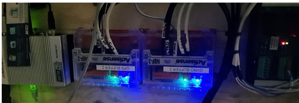
Figur 11: Eksempel på tilkoblingspunkt for GPS og kursdata ombord på havfiskefartøy
