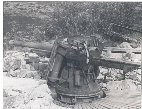
10,5 cm K331(f) ombygd til sokkellavett. Også brukt av Kystartilleriet frem til 1958.
