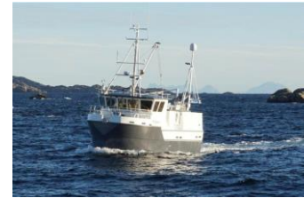
Eksempel på ladbart fartøy: Diesel/batterihybrid «Korsnesjenta», bygget på Ballstad Slip. Foto: Roger Abrahamsen
