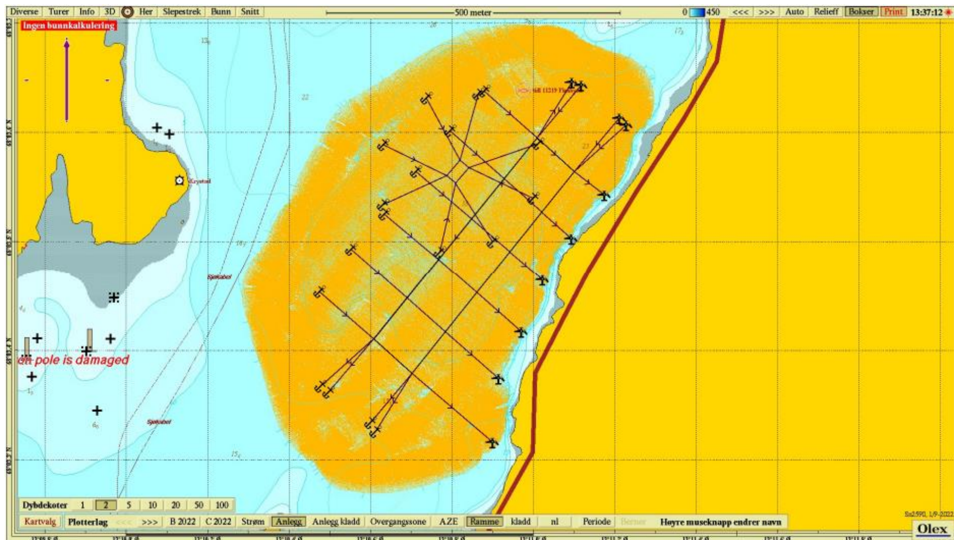
Figur V1.6.3 Anleggsramme plassert over egenmålte bunndata – oppløsning (loddskudd). Kartet er orientert mot nord og datum er WGS84. Egenmålte bunndata (Åkerblå AS) gjennom programvaren til Olex AS (2022).
